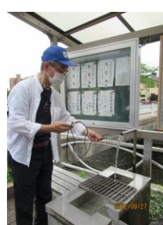
一般細菌と大腸菌群の試験紙を水に浸して慎重に保管
